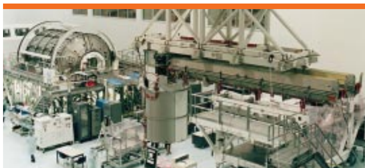
← Zij aan zij de Italiaanse mini-module Leonardo voor onderhoudswerk en de structuur voor de rollen met zonnecellen voor de elektrische energievoorziening van het International Space Station. (Foto NASA).
