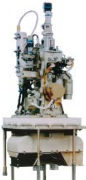
↑ Het laboratorium van Dr. G. Pétré ontwikkelde deze FAST-apparatuur (Facility for Absorption and Surface Tension) om de processen te bestuderen die zich aan vloeibare scheidingslagen afspelen. (Doc. ULB)
