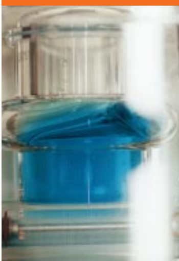
← Deze configuratie van een scheidingslaag tussen een vloeibare en gasachtige toestand werd verwezenlijkt tijdens de missie USML 1 (United States Microgravity Laboratory) in juli 1992. Daaruit kan men beter begrijpen hoe vloeistoffen en gassen in wisselwerking zijn. (Foto NASA)
